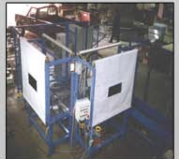
Protection de Machines Enroulables
